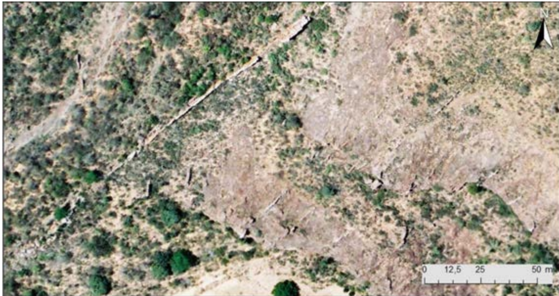
Figura 1- Fotografia aérea mostrando dois sistemas de falhas na sub-bacia de Tucano Norte. Sistemas de falhas NE, mais desenvolvido e NS (NNW-SSE) representado por segmentos mais curtos, ambos relacionados com o desenvolvimento de bandas de deformação.
