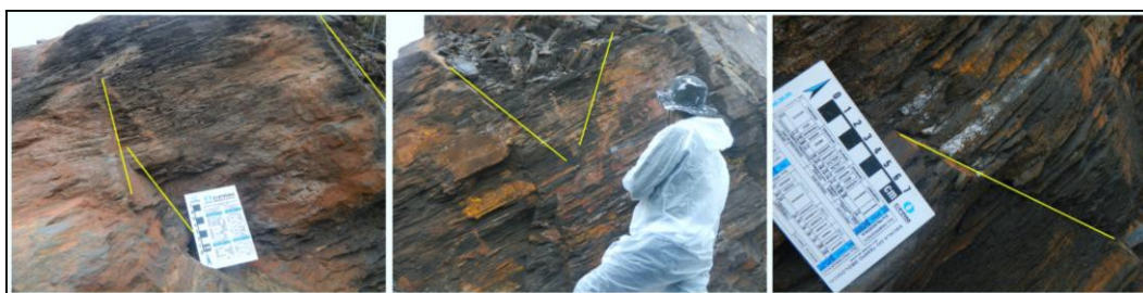
Figura 5: Famílias de fraturas sub-verticais e sub-horizontais em itabirito da Formação Cauê.
