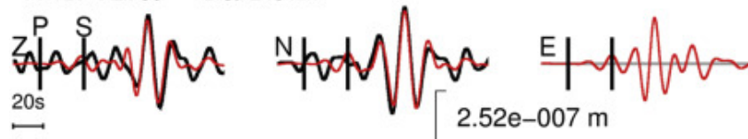
Figura 4: Ajuste de forma de onda entre o sismograma observado (preto) e o sintético (vermelho) para o sismo de Miranda de 2015. São mostrados os sismogramas das estações AQDB e PP1B na componente vertical (Z), norte-sul (N) e leste-oeste (E) com a marcação da chegada da onda P e S. É apresentada a solução focal obtida usando a forma de onda (Assumpção et al. , 2016) bem como polaridades de primeira chegada de onda P (cruzeiros indicam compressão e círculos são dilatação). A linha tracejada é o plano de falha obtido por meio da localização das réplicas.
