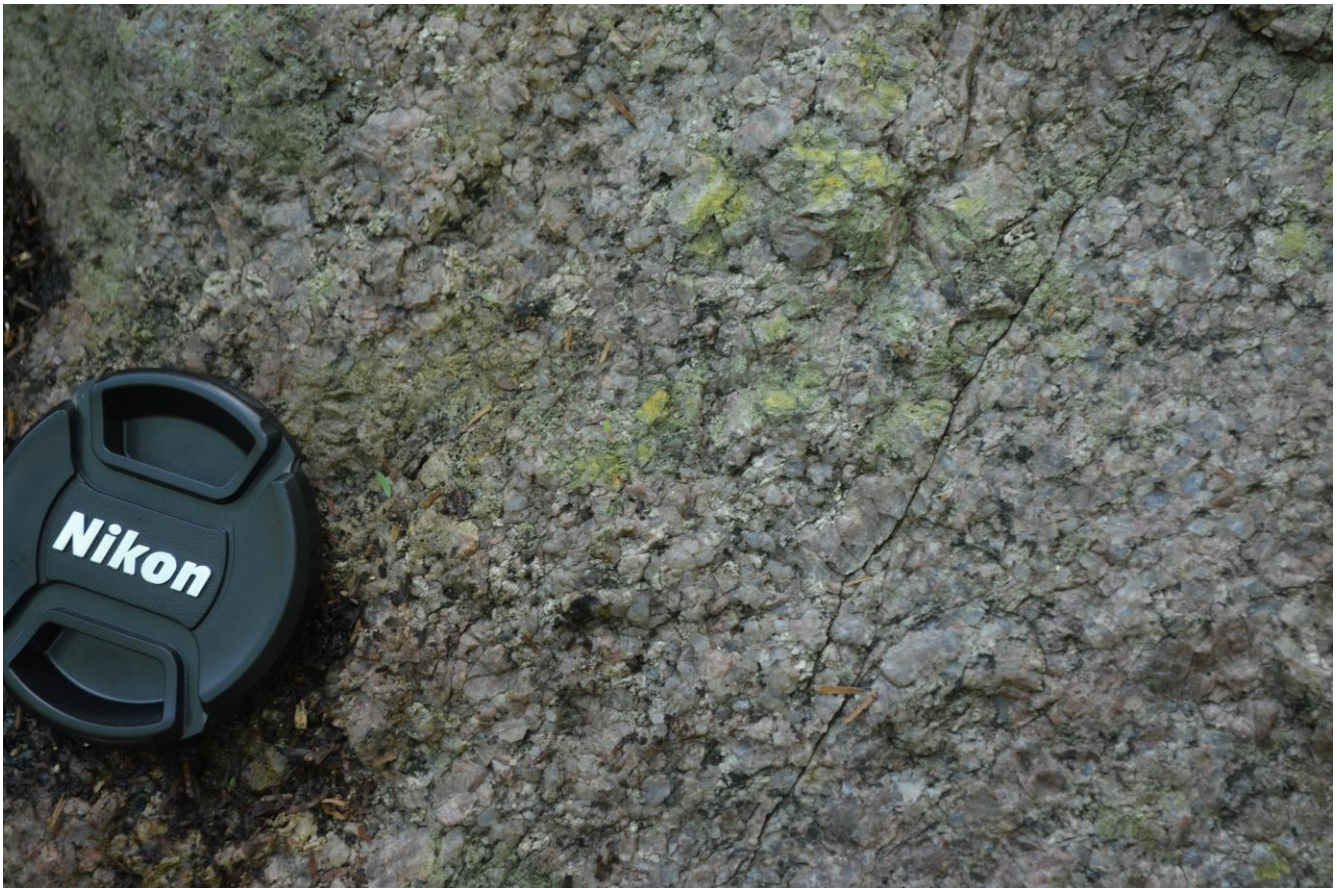
Figura 2. Aspecto macroscópico do Granito Tasseoro, destaque para a textura isotrópica e fraturas.
