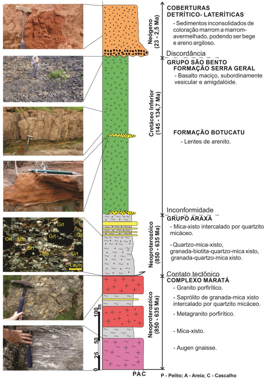
Figura 2: Coluna estratigráfica esquemática levantada na Folha Goiandira e ilustração do litotipo mais representativo de cada uma das unidades.
