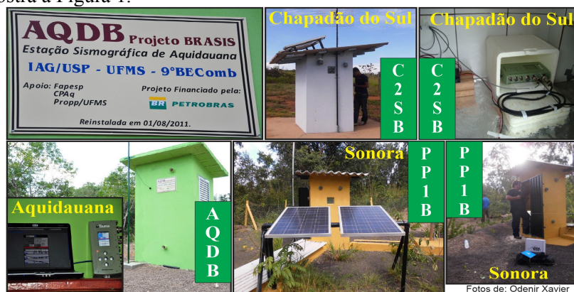
Figura 1: Estações sismográficas instaladas no Estado de Mato Grosso do Sul, com silos, painéis, antenas e registradores instalados.
