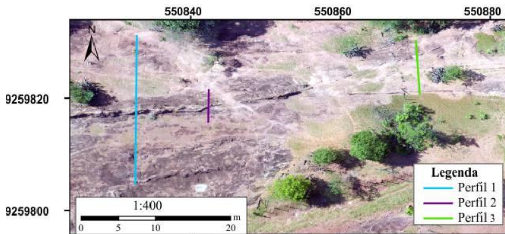
Figura 2: Localização dos scanlines a partir do imageamento feito por drone.
